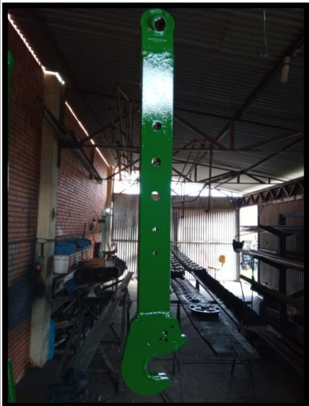
Para realizar a pintura após a instalação dos ganchos , proceda uma lavagem com solventes para retirar totalmente os resíduos da solda e fuligens.
