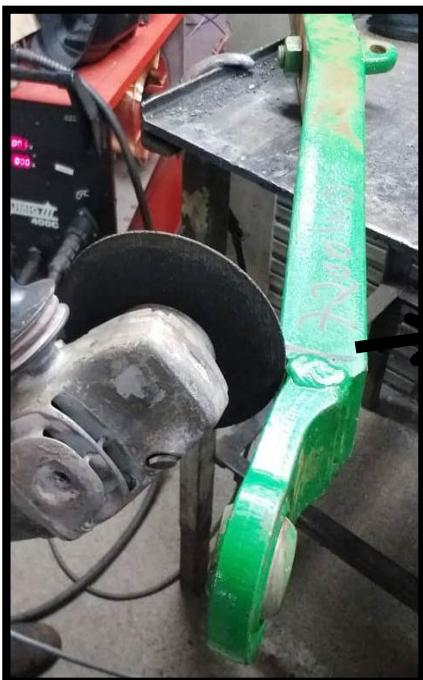
Proceder o corte utilizando uma lixadeira com disco de **corte**.
