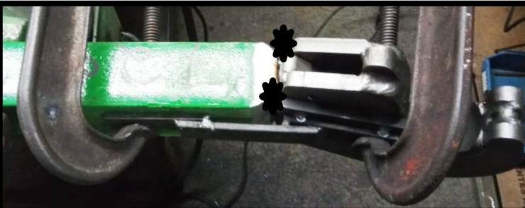
APÓS REALIZAR O PONTEAMENTO, VERIFICAR OS ALINHAMENTOS VERTICAL E HORIZONTAL
